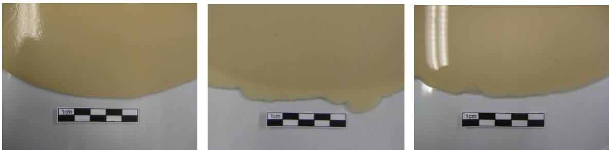
Abbildung 36 Verlaufsfränder bei Fließmittelüberdosierung, links: 2,0 % Melcret, mittig: 0,15 % Melflux, rechts: 0,15 % Melflux plus (Fließmaß ca. 300 mm, \beta -HH, l/s = 0,7 )
